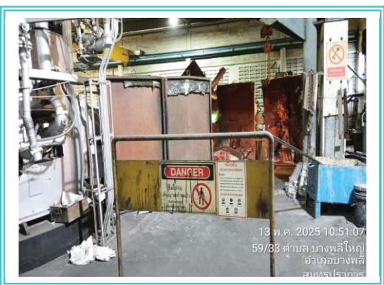
รูปที่ 3-30 ป้ายเตือนบริเวณสัมผัสผิสร้อน พร้อมโซ่เหล็กกันและฉากกันความร้อน
