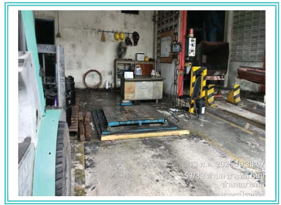
รูปที่ 3-10 ที่ซังน้ำหนักรับควบคุมรถบรรทุกไม่ให้เกินพิกัด
