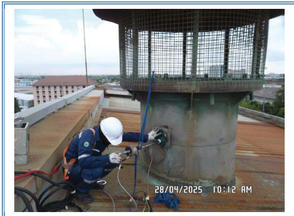
รูปที่ 4-34 แสดงการตรวจวัดปริมาณสารเจือปนในอากาศ ที่ระบายออกจากปล่องระบายเตาหลอม เก็บตัวอย่างในวันที่ 28 เมษายน 2568
