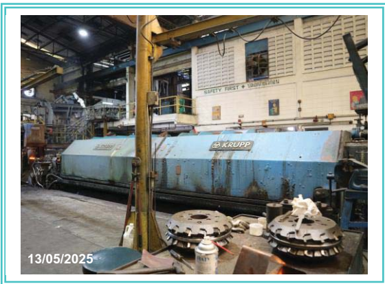
รูปที่ 3-27 เครื่องจักรมีฝาคอร์บลดความดัง
